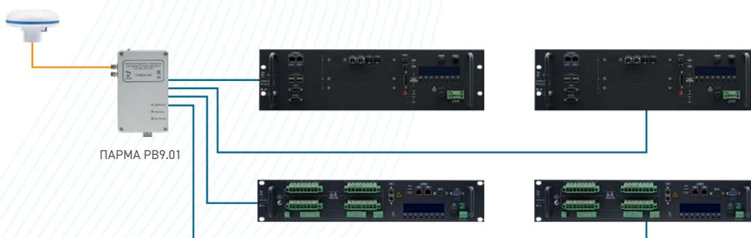
Подключение до 8 устройств от имеющегося на объекте сервера времени с выходом IRIG-B с применением оптического транслятора ПАРМА OT-8 по оптическим каналам связи (многомодовым) до 1 км, прямое подключение по IRIG-B
